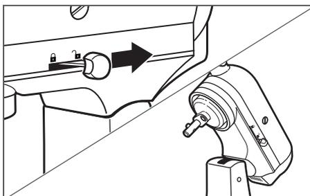
**2** Sostenga la palanca aseguradora en la posición de desbloqueo e incline hacia atrás el cabezal del motor.
