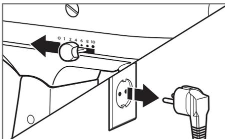
**1** Para montar el accesorio: Asegúrese de que la batidora esté apagada (control de velocidad en posición "0"). Desenchufe el robot de cocina.
