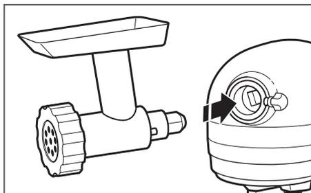
**3** Introduzca el alojamiento del eje del accesorio en la toma de accesorios, asegurándose de que el árbol de transmisión del accesorio encaja en el receptáculo cuadrado de la toma de accesorios. Puede ser necesario girar el accesorio hacia atrás y hacia adelante. Cuando el accesorio está en la posición correcta, el pasador del accesorio encajará en la muesca del borde de la toma.
