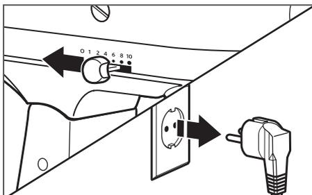
**6** **Para desmontar el accesorio:** Asegúrese de que la batidora esté apagada (control de velocidad en posición "0"). Desenchufe el robot de cocina.
