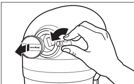
**2** Afloje la tuerca de accesorios, girándola en el sentido contrario al de las agujas del reloj. Quite la cubierta de la toma de fijación.
