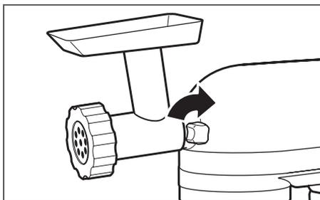
**4** Apriete la tuerca de accesorios, girándola en el sentido de las agujas del reloj hasta que el accesorio esté totalmente fijado al robot de cocina.
