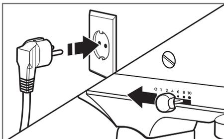
**1** Enchufe el robot de cocina a la toma de corriente eléctrica adecuada. Para comenzar, y a fin de evitar que los ingredientes salpiquen fuera del bol, sitúe la palanca de control de la velocidad en la velocidad más baja y, a continuación, aumente la velocidad gradualmente. Consulte la sección "Guía de control de la velocidad".
