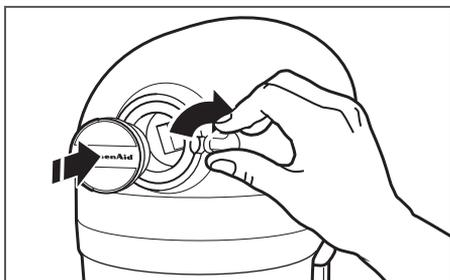
**8** Vuelva a colocar la cubierta de la base de fijación del accesorio. Apriete la tuerca de accesorios, girándola en el sentido de las agujas del reloj.
