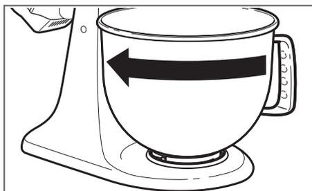
**3** Coloque el bol en la placa de sujeción del bol. Rote suavemente el bol en la dirección de las agujas del reloj.
